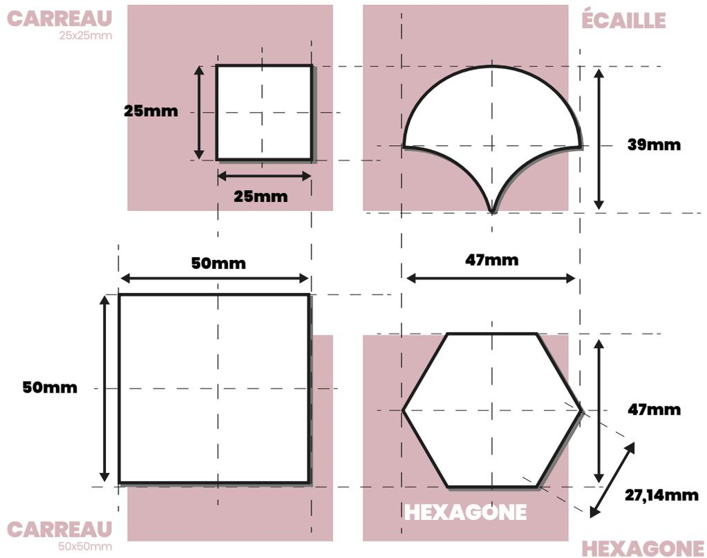
La distance donnée est du milieu du joint jusqu'au milieu du joint
